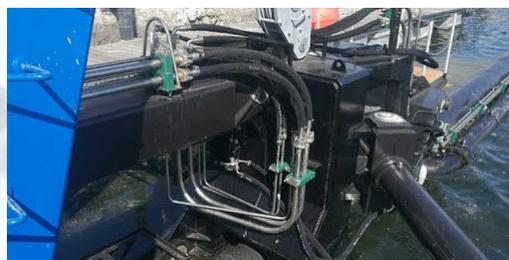
Fabrication de **flexibles hydrauliques** avec une **unité dédiée** qui dispose de **véhicules équipés** prêts à intervenir
